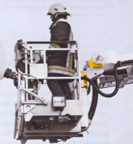
Kompakt und leicht ist der optimierte Drehantrieb für Arbeitsbühnen.
