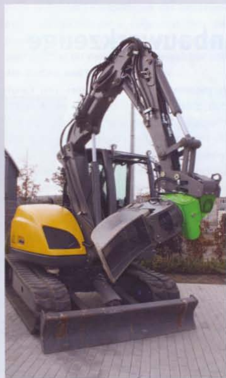
Mit dem neuen hydraulischen Drehantrieb XtraTilt sowie dem TiltRotator präsentierte HKS auf der Bauma 2010 zylinderfreie Schwenktechnik für Baumaschinen. | Fotos: HKS
