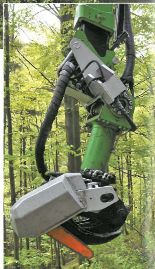
Oben: Am neuen Tiltrotor ist jetzt eine Greifersäge befestigt. Der Rotor dreht um 280 Grad und ist um 240 Grad kippbar. So kann man gezielt zupacken und zum Beispiel Äste aus dem Kronenbereich sicher greifen, abschneiden und zielgenau ablegen (großes Foto oben). Fotos: Biernath
