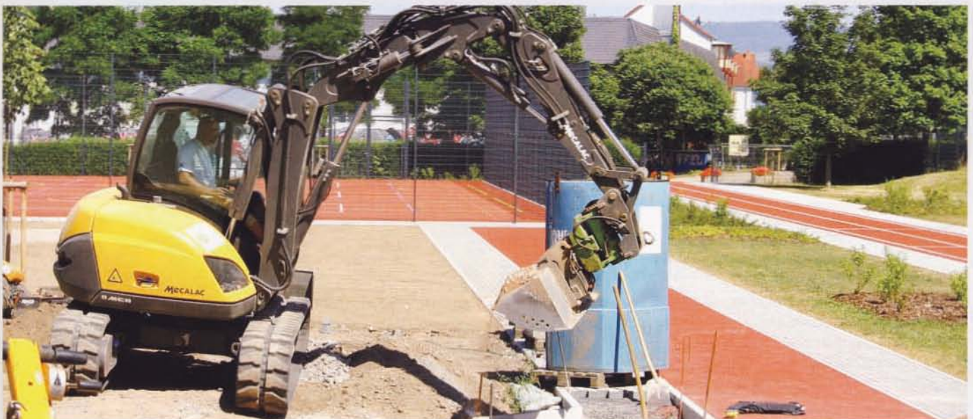
Dank seiner Gummi-Raupenketten hat die 7-Tonnen-Maschine nur einen Bodendruck von 0,31 kg/qcm.
