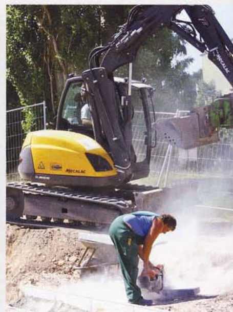
Schwer zugängliche Stellen erreicht der kompakte Mecalac 8MCR bei zurückgelegtem Ausleger spielend.
