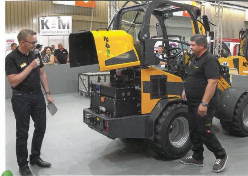
Mit dem neuen Elektrolader 24e von Schaeffler können Abgase und Lärm der Vergangenheit angehören. Ein besonderer Vorteil in emissionsensiblen Bereichen wie Wohngebiete, Garten- und Parkanlagen, Innenstädte oder auch Friedhöfe sowie dem Arbeiten innerhalb von Gebäuden. Er verfügt über zwei Elektromotoren für Antriebs- und Fahrhydraulik und ein Power-Batteriesystem, das nach Anbieterangaben in nur 30 Minuten auf 80 % geladen werden kann.
