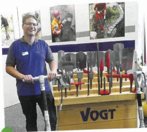
Am Stand von Vogt Baugeräte zeigte Geschäftsführer Andreas Brehm einen Turbospaten. Eine 18 mm starke Aufnahme, hohe Schlagkraft für zügiges Arbeiten und eine rückenschonende Arbeitshaltung gelten als Vorzüge des universellen Druckluftspatens.
