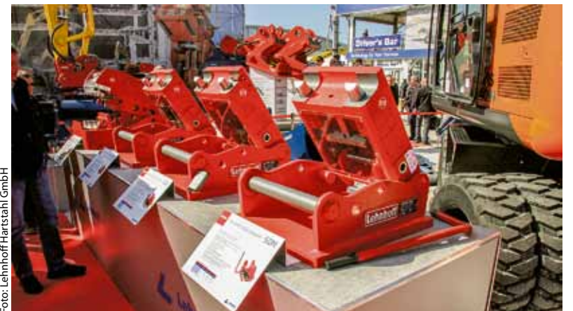
Die neuen symmetrischen Schnellwechsler für Bagger von 12 bis 70 Tonnen Betriebsgewicht.
