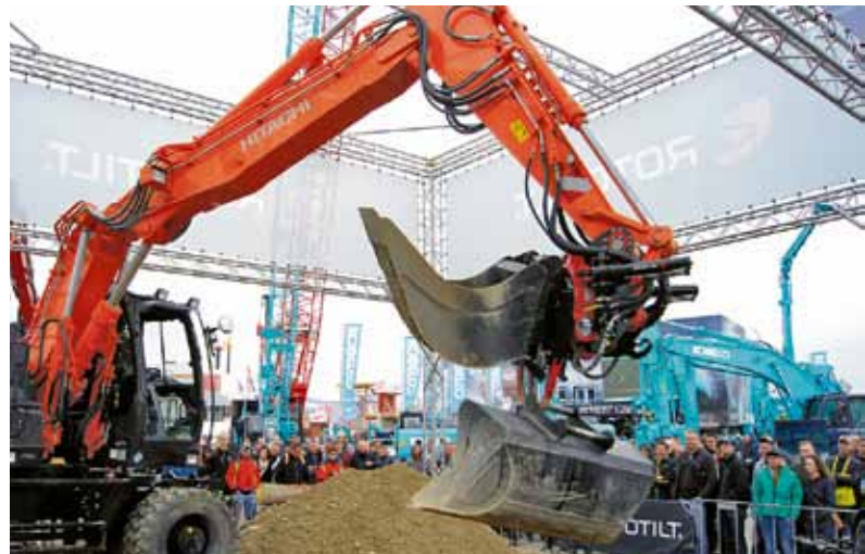
Der neue Schwenkrotator lässt sich mit dem intelligenten Steuersystem ICS sowie dem Schnellwechslersicherheitssystem SecureLock bestücken und mit Hilfe der Rototilt Positioning Solution (RPS) in ein Baggersystem integrieren.
