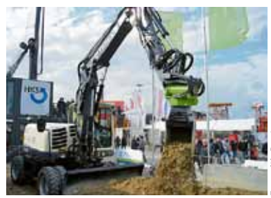
Live-Demonstration: Der Aktionsradius des Trägergerätes erweitert sich mit einem HKS-TiltRotator stark. Im Ergebnis muss der Bagger nur wenig bewegt werden. Das spart Zeit, Geld, Sprit und schon die Umwelt.
